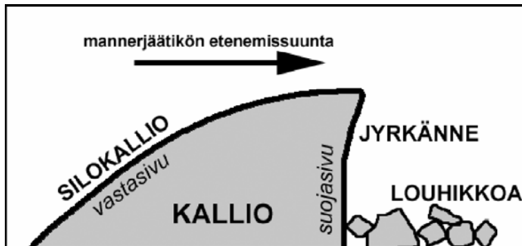
Kaavio 2. Kalliiojyrkänteiden sijainti suhteessa mannerjäätikön etenemissuuntaan
